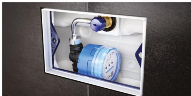
Rinçage hygiénique Rapid Geberit : à intégrer provisoirement dans l'installation pour garantir le renouvellement de l'eau potable (toutes les 72 heures) jusqu'à l'exploitation conforme à la destination. Ses dimensions compactes et l'alimentation par pile permettent une intégration ultérieure.
