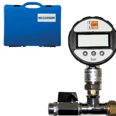
Manomètre numérique Nussbaum: pour l'essai d'étanchéité et de résistance avec une eau jusqu'à 85°C.
